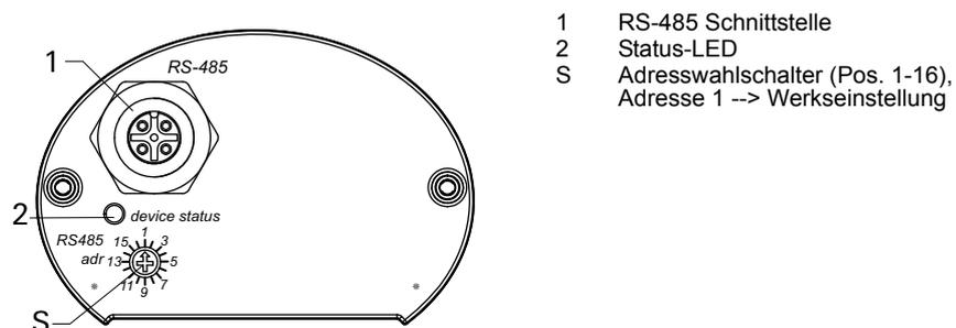
Fig. 2: DigiLine CPT 200 in Standardausführung
