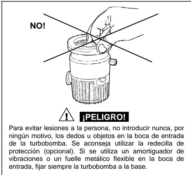
La turbobomba se puede instalar en cualquier posición. Fijar la turbobomba en posición estable uniendo la brida de entrada de la turbobomba con una contrabrida fija capaz de resistir a un par de 200 Nm alrededor de su eje, o utilizando el kit opcional apropiado para la fijación a la base.
