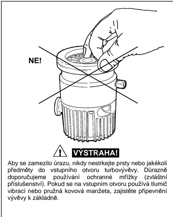
Tuto vývěvu lze instalovat v libovolné poloze. Turbodávku upevněte v nějaké stabilní poloze a přívodní přírubu turbodávky připojte k pevné protipřírubě, která snese torzní moment 200 Nm kolem své osy, nebo použijte doplňkovou soupravu pro upevnění k základně. Turbomolekulární vývěva se vstupní přírubou ISO se musí připevnit k vakuové komoře použitím příslušných spon a přichytek. Následující tabulka uvádí nezbytný počet spon a přichytek pro každé přichytné zařízení a příslušný utahovací moment.
