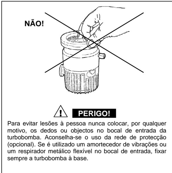
A turbobomba pode ser instalada em qualquer posição. Fixar a turbobomba em posição estável ligando a flange de entrada da turbobomba a uma contraflange fixa capaz de resistir a um torque de 200 Nm ao redor do próprio eixo, ou utilizando o kit específico opcional para a fixação à base.
