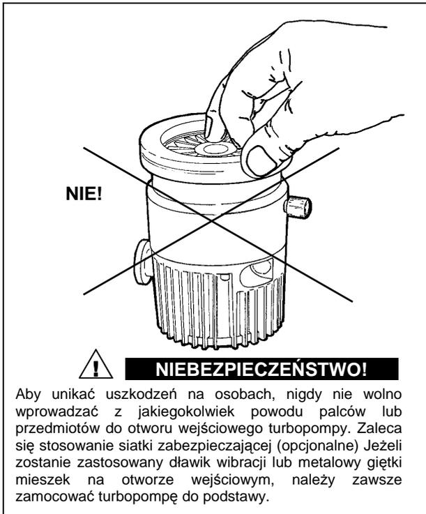
Aby unikać uszkodzeń na osobach, nigdy nie wolno wprowadzać z jakiegokolwiek powodu palców lub przedmiotów do otworu wejściowego turbopompy. Zaleca się stosowanie siatki zabezpieczającej (opcjonalne) Jeżeli zostanie zastosowany dławik wibracji lub metalowy giętki miśszek na otworze wejściowym, należy zawsze zamocować turbopompę do podstawy.
