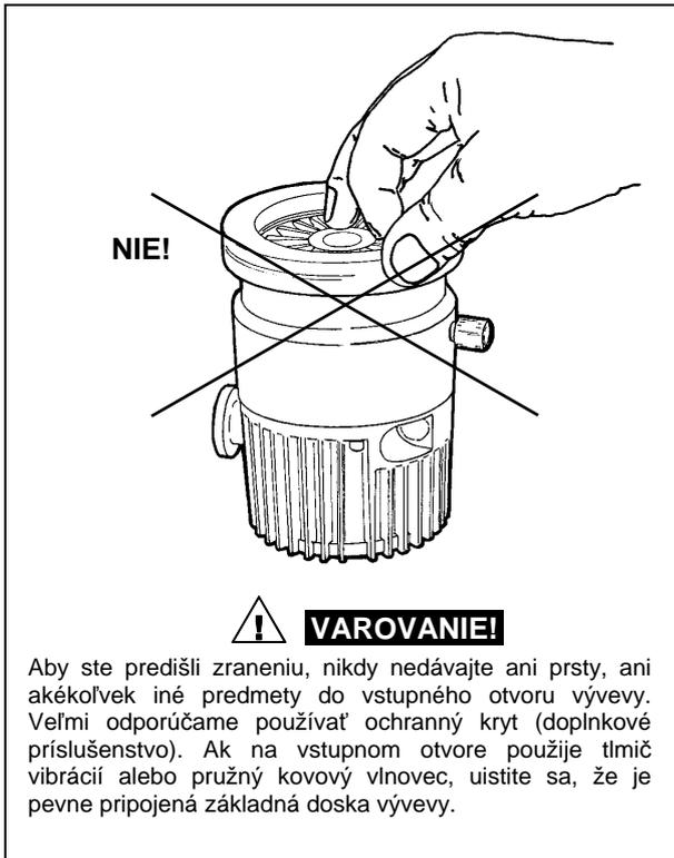
Výveva môže byť nainštalovaná v ľubovoľnej polohe. Upevnite turbovývevu do stabilnej polohy pripojením vstupnej príruby turbovývevy k pevnej prírubе, upevnenej tak, aby vydržala namáhanie krútiacim momentom 200 Nm okolo svojej osi, alebo použijete doplnkovú súpravu pre upevnenie pomocou základnej dosky.
