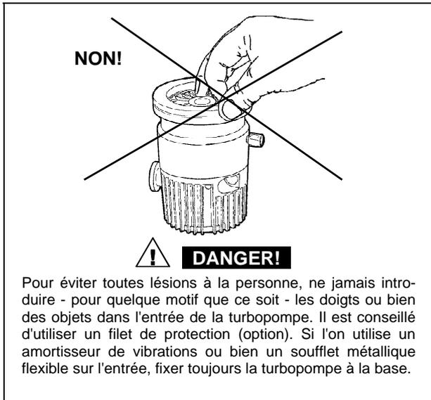
La turbopompe devra être installée en position verticale ou en position retournée avec une inclinaison maximum de 10° par rapport à l'axe vertical.
