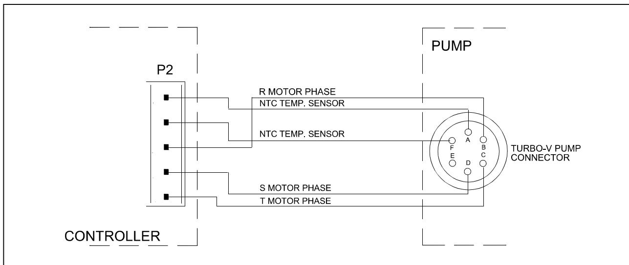
*Verbindungsleitung zwischen Controller und Pumpe*
